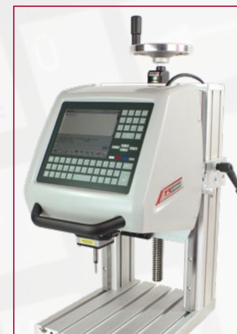
Jelölőgép állvány, tekerős magasság állítással (opcionális)
